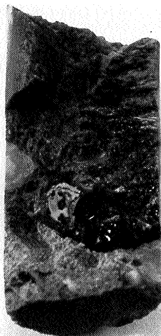
13 Kern 2W na 9 minuten, ontkleuring nabij de wapening duidt op productie van een overmaat aan alkaliën
