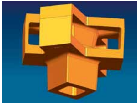
Er zijn 20 gietsknoepen toegepast van 3 verschillende typen.
